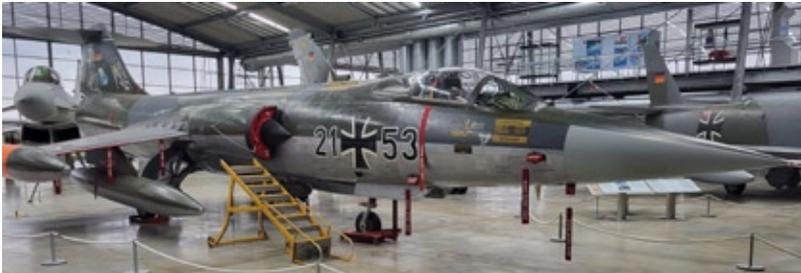
Die Länge beträgt 16,66 m, die Spannweite beträgt nur 6,68 m. Das bedeutet, es war alles für extrem hohe Geschwindigkeit optimiert worden. Folgerichtig wurde eine Höchstgeschwindigkeit von etwa 2400 km/h erreicht, wobei das normale Startgewicht etwa 10 t betrug.
