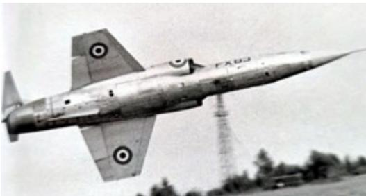
Auffällig sind die Flügel der F-104. Sie sind sehr kurz, trapezförmig und scharfkantig. Nach der Landung musste sofort eine Gummileiste angebracht werden, damit sich keiner verletzt. Diese kleinen Tragflächen ermöglichten eine
