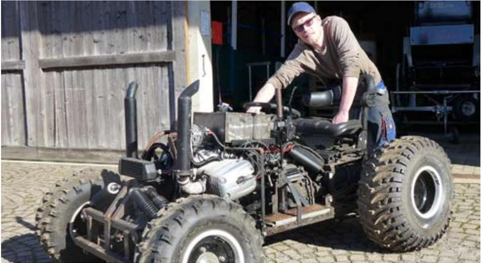
Vierventil-Boxermotor mit ca. 110 PS stammt aus einer ausgeschlachteten BMW, Verteilergetriebe mit Kardanwelle nach vorne und Vorderachse sind Reste eines kleinen Suzuki-Jeep, die hintere Radaufhängung war früher in einem Suzuki LJ 410 verbaut und das hintere Differenzial kommt aus einem 190er
