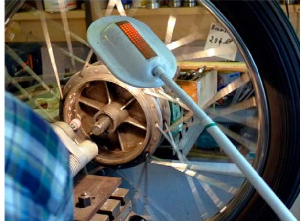
*Ein Schleifstift aus Edelmetall bearbeitet den Bremsring mit 60.000 U/min und sorgt für eine makellose Oberfläche und perfekten Rundlauf.*
