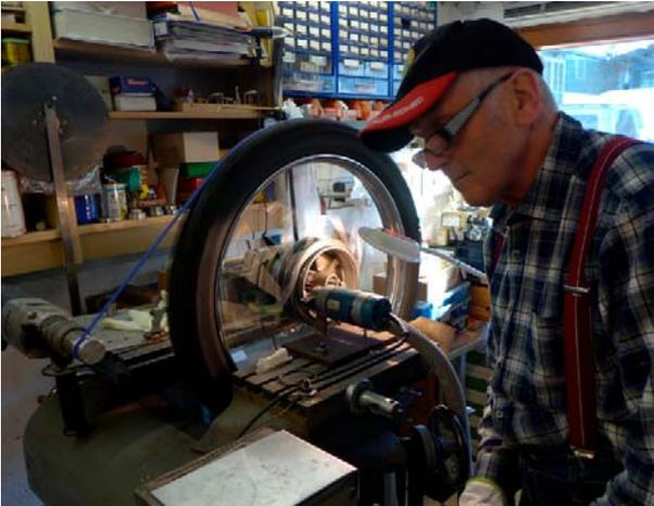
*Als erstes kommt die Bremstrommel an die Reihe. Das komplette Rad wird eingespannt und per Bohrmaschine und Gummischnur auf Touren gebracht.*
