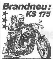
Wassergekühlter 17-PS-Motor (neue Versicherungsklasse), 5 Gänge, Alu-Druckgußräder, Scheibenbremse. Führerschein 1, ab 18 Jahren.
