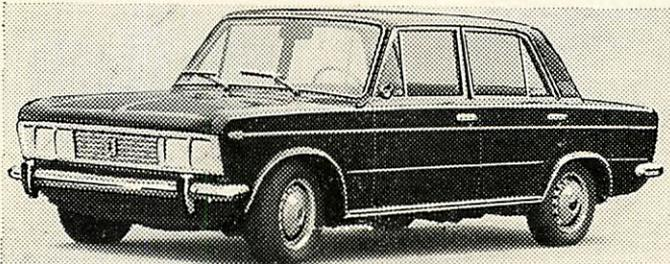
*1597 ccm - 100 PS - 2 obenliegende Nockenwellen - fünffach gelagerte Kurbelwelle - Höchstgeschwindigkeit ca. 170 km/h - 5 Vorwärtsgänge - 4 Servo-Scheibenbremsen - Zwei-Kreis-Bremssystem - 4 Jod-Halogen-Scheinwerfer - Bouclé-Teppiche im ganzen Wagen.*
