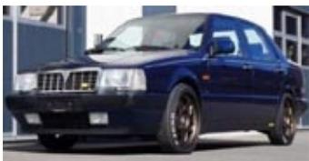
308 GTB, hatte 32 Ventile und wurde entsprechend überarbeitet für den Einsatz im Lancia Thema (Bild blaues Auto). Äußerlichkeiten im Unterschied zur sonstigen Massenware: Edelstahl Kühlergrill, Räder mit 5 Speichen, handgemalter Zierstreifen in Höhe der Gürtellinie. Der Heckflügel
