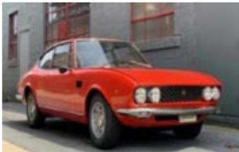
Houzer dort mit einem FIAT Dino (Bild roter Wagen). Ein besonderes Fahrzeug: Ferrari Sechszylinder-V-Motor inkl. drei Weber-Vergaser. Der Dino wurde mit 1988 cm<sup>3</sup> und 160 PS bzw. von 1969 bis 1972 dann mit 2418 cm<sup>3</sup> und 180 PS angeboten. Die Innenausstattung strahlte Flair und Atmosphäre aus. In Chrom gefasste Rundinstrumente und
