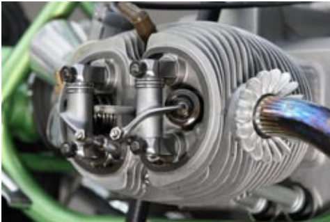
Drehzahlfest: Radial-Nadellager für die Kipphebel und spezielle Stoßstangen
