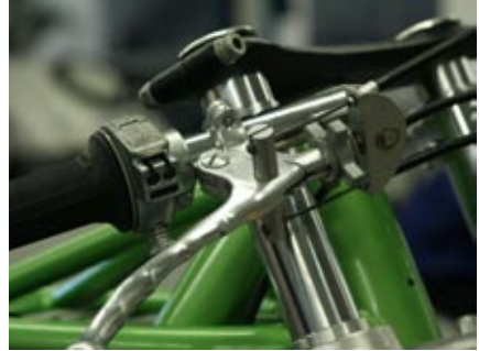
Die „Waage“ bringt gleichmäßigen Zug auf die Backen der Fontana-Bremse
