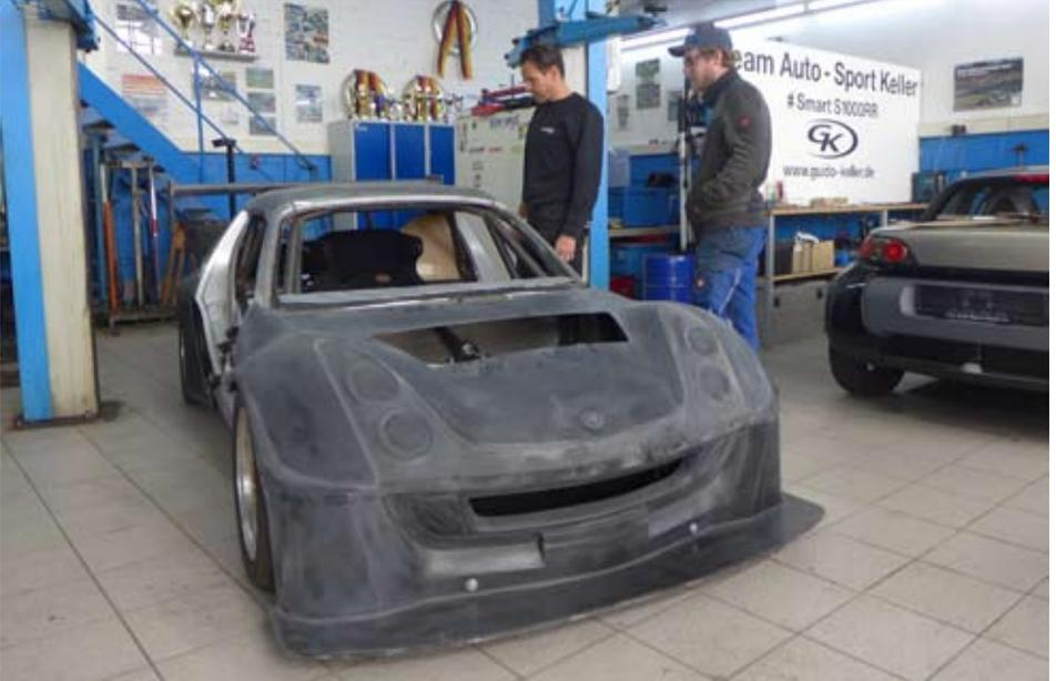
*Guido Keller's Renn-Smart ist fast fertig. Die komplette Verkabelung der Elektrik und Elektronik sowie die Auspuff- und Schalldämpferanlage sind eingebaut. Zur Zeit in Arbeit sind die Lackierung und die (auf dem Foto noch fehlenden) Spezial-Federbeine.*
