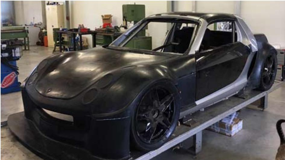
*Der "Bergrenn-Smart" von Guido Keller (siehe auch Heft Nr. 3) nimmt weiter Formen an. Inzwischen ist eine superleichte Karosserie - in Fachkreisen auch Bodykit genannt - aus Kohlefaser (sie wiegt nur 12 kg) bei der Fa. Floßmann Design in Niederbayern entstanden. Bis zur ersten Probefahrt wird es allerdings noch eine Weile dauern. Ich bleibe am Ball.*
