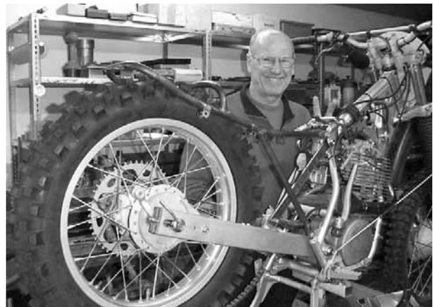
Lazi's 2/4-Takter, ein stets bestauntes Einzelstück, leidet an Materialermüdung und benötigt ein neues Rahmenheck. Wenn es also im Hause Peres blitzt und raucht, dann ist ein WIG-Schweißgerät zur Instandsetzung des überaus filigranen Werks aus dünnwandigen Spezialrohren in Aktion. Danach soll das edle Teil wieder in diversen Wettbewerben für klassische Geländemaschinen zum Einsatz kommen.
