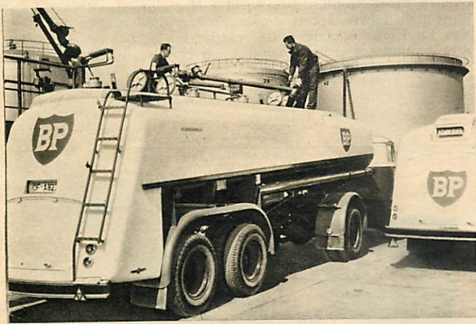
Auch bei den Tankwagen werden alle erdenklichen Vorsichtsmaßnahmen getroffen. Unser Bild zeigt einen der modernsten selbsttragenden Tankwagen-Sattelschlepper. Die 21000 Liter Benzin, die dieser Wagen faßt, werden in vier Abteile gefüllt.
